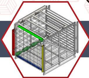
Le kit se compose de 4 tubes à boulonner sur chaque côté du container de remuage.
